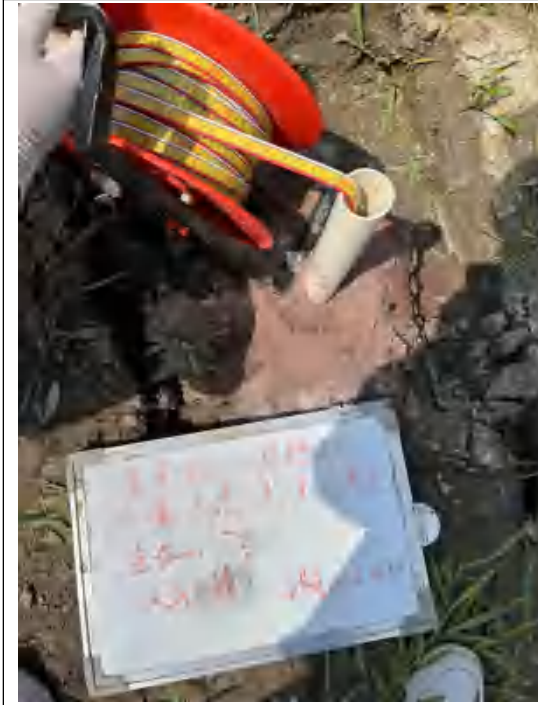
D1 采样前水位测量
