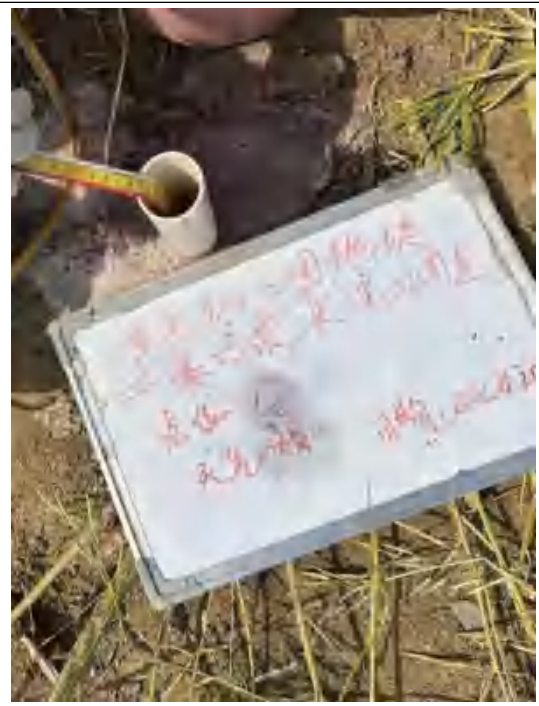
D0 采样前水位测量
