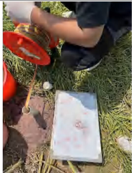
D2 采样前水位测量
