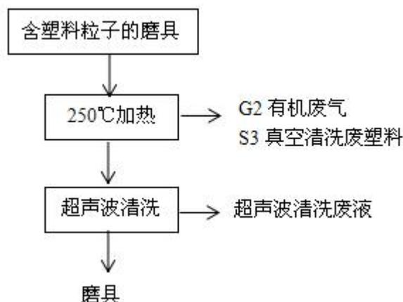
图 5-2 模具清洗工艺流程图
