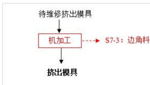
图 5-7（2） 厂内挤出模具维修工艺
